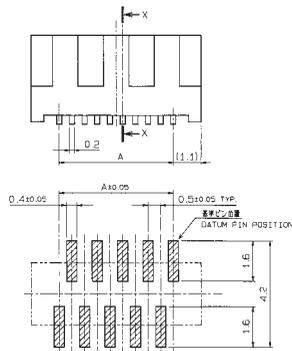
基板取り付け寸法 (コネクタ搭載面側)
